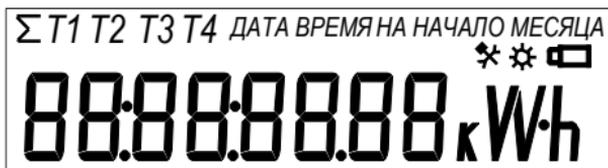
Рисунок 3.1 – Режим теста ЖКИ счетчика
