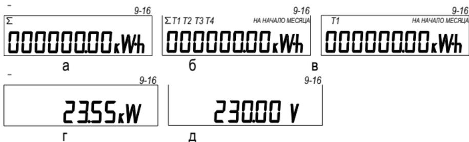
Рисунок 3.3 – Программируемые режимы индикации счетчика
